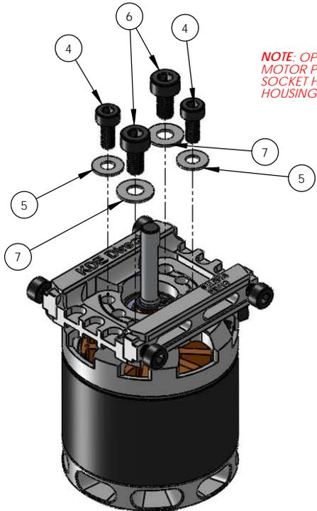
**NOTE:** OPTIONAL KDE DIRECT 450XF-3500 HP BRUSHLESS MOTOR PROVIDES ABILITY FOR DUAL M2.5 AND M3 SOCKET HEAD CAP SCREW ATTACHMENT TO THE MOTOR HOUSING FOR ULTIMATE STRENGTH AND SECURITY
